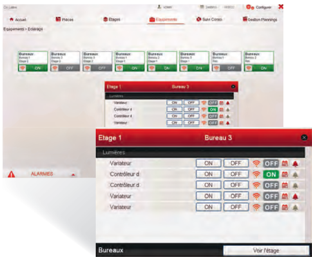
Visualisation et pilotage des éclairages : vision globale et détail par espace
