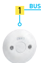
Ecodécteur 360° double technologie (infrarouge + ultrasonique) Portée Ø 8 m
